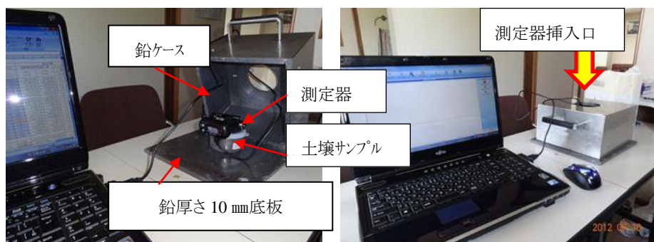
図-3 バックグラウンド遮蔽機器による測定システム全景
