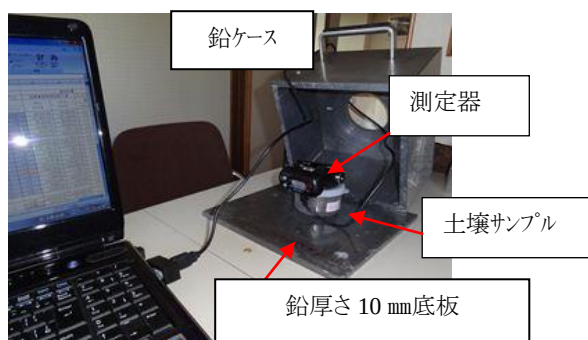
Fig-3 バックグラウンド遮蔽機器による測定システム全景
